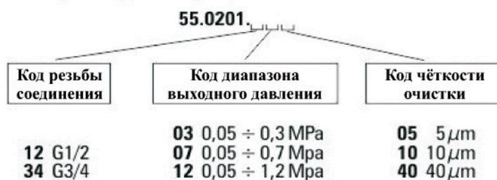
Пример обозначения фильтрующе-редукционного комплекса сжатого воздуха G1/2 с выходным давлением 1,2 МПа и чёткости фильтра 10 µm: **55.0201.1212.10**
