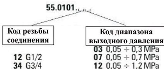
Пример обозначения редукционного клапана типа «ГОРНЯК» G1/2 с выходным давлением 1,2 МПа: **55.0101.1212**
